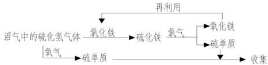
图 5-1 脱硫净化工艺流程图
